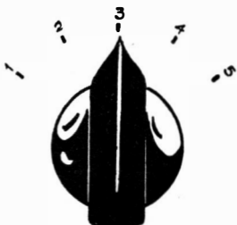
FIG. 5. — Una perilla que acciona una llave selectora sólo tiene varias posiciones fijas indicadas con números o leyendas.
