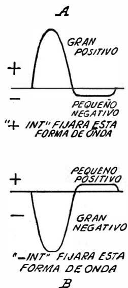
FIG. 131. — Razones para que el aparato tenga selector de polaridad.
