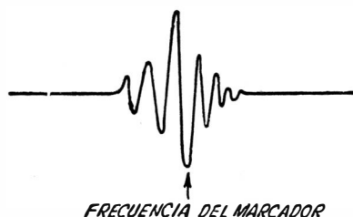
FIG. 146. — La marca es una oscilación de alta frecuencia que se inyecta en la señal del equipo en prueba.
