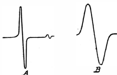
FIG. 170. — Curva obtenida en el osciloscopio sobre el discriminador.
