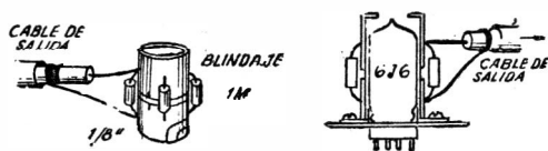
FIG. 163. — Forma de inyectar la señal del aparato al televisor.
